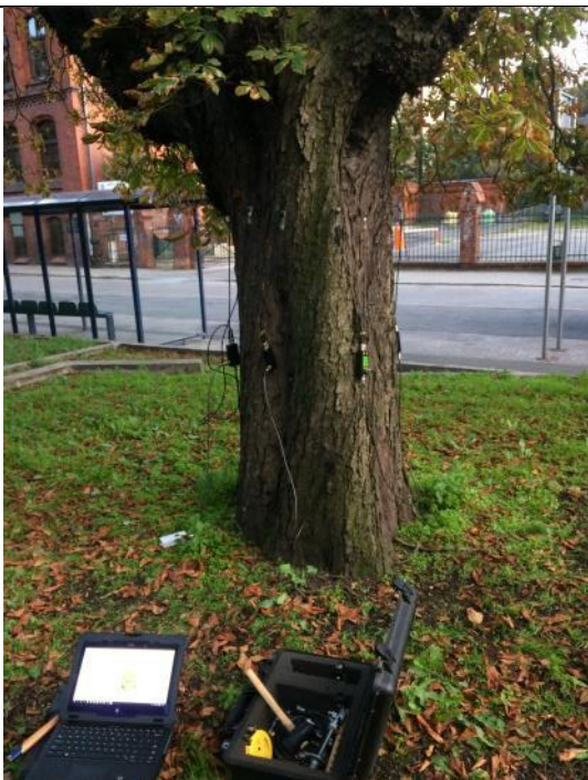
Fot. 2-7 Kasztanowiec 2, Pl. Kościeleckich, Bydgoszcz. Podczas badania tomografem sonicznym
