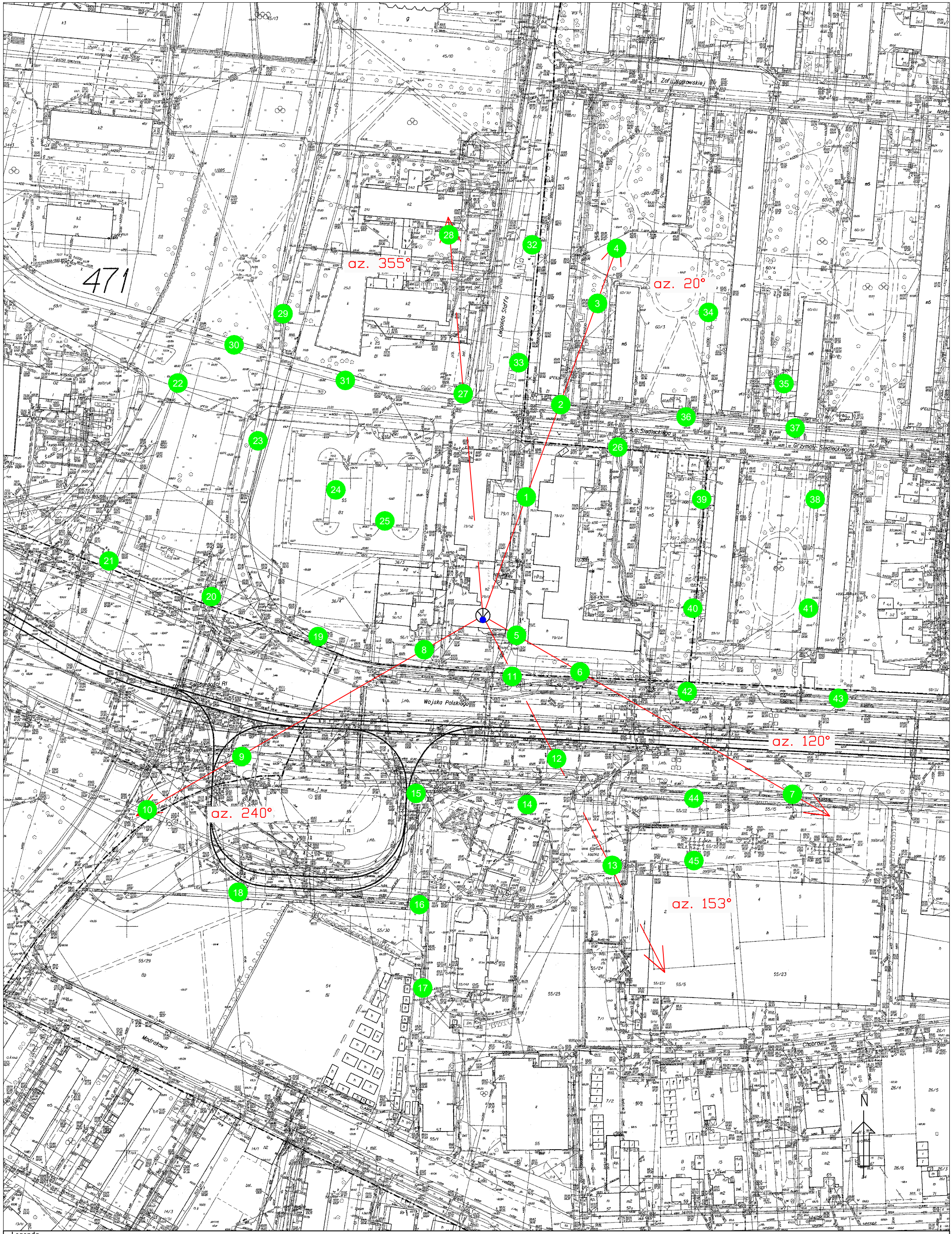
Rys.1 Lokalizacja pionów pomiarowych
