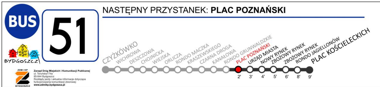
Rysunek nr 2a – Tablica boczna wewnętrzna – linia 51 (półkurs, kierunek przeciwny- wariant podstawowy, przebyte odcinek oznaczony na szaro)
